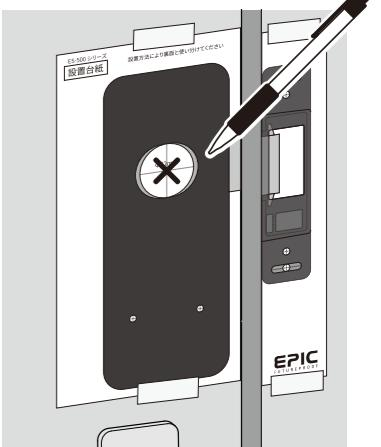
直径32mmの穴の中心に印を付けます。ネジ穴を開ける必要がある場合はネジ位置にも印を付けますが、後ほど位置を微調整する可能性があります。ネジ留めをする直前まで、穴を開けないようにしてください。
