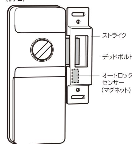
※取り付け完了後、必ずドアを開けた状態で、登録・設定作業を行ってください。
