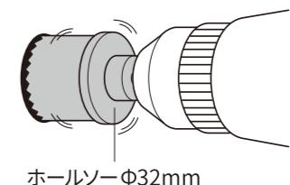
取り付け位置を決定したら、印に合わせて穴を開ける。
